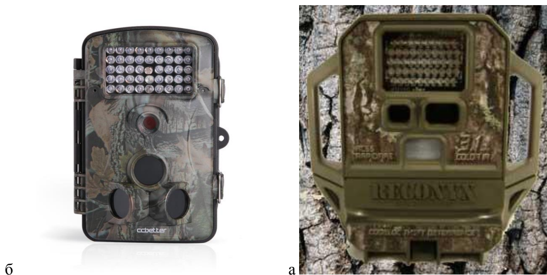
Рис. 5.1. Основні типи автоматичних фотокамер, що використовувались впродовж досліджень, а) ССBetter, б) ReconyxRapidFire RC60.
