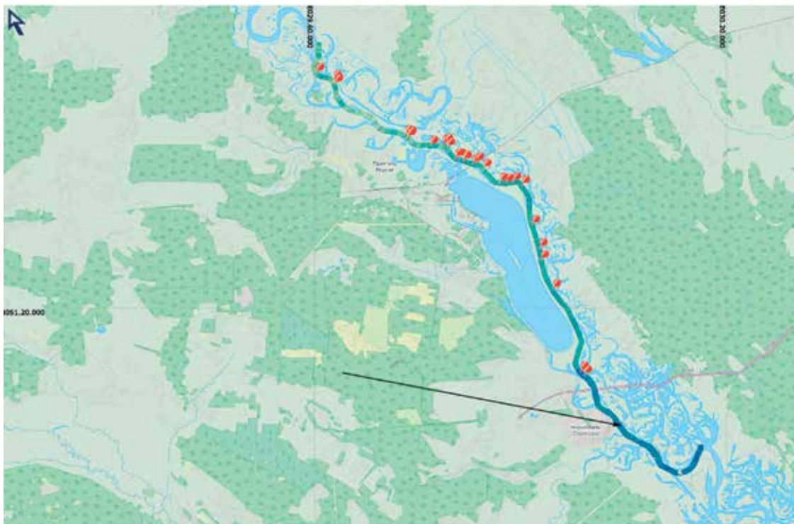
Рисунок 5.22 – Схема поширення густини верхнього шару донних відкладів дослідженої ділянки р. Прип'ять (позначено виявлені об'єкти, р. Прип'ять, 14–16 серпня 2019 р.)
