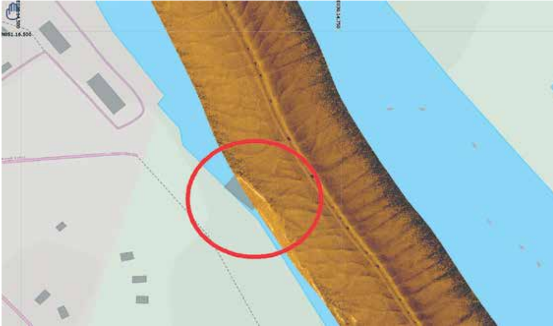
Рисунок 5.15 – Ехограма гідролокатора бічного огляду, на якій зафіксовано частково затоплене судно (р. Прип'ять, 2019-08-15, t=15:12:19 , 051^{\circ} 25,037' N , 030^{\circ} 06,314' E , довжина судна близько 23 м)
