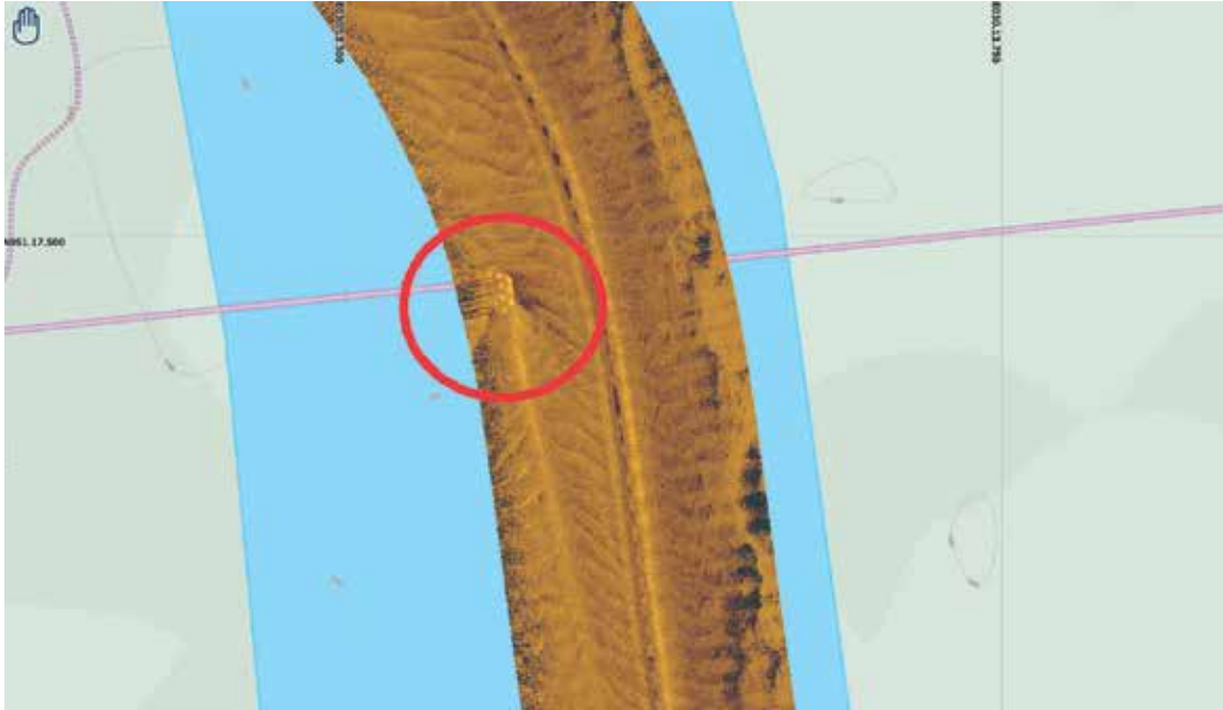
Рисунок 5.17 – Ехограма гідролокатора бічного огляду з результатами обстеження опори залізничного моста (р. Прип'ять, 2019-08-15, t=12:59:11 , 051^{\circ} 24,423' N , 030^{\circ} 07,657' E )
