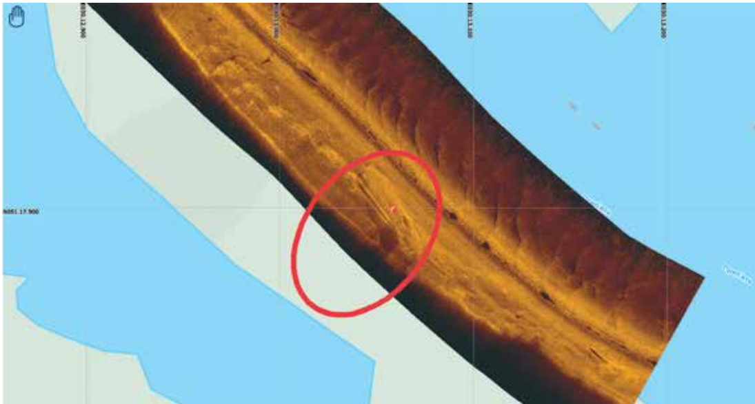
Рисунок 5.7 – Ехограма гідролокатора бічного огляду, на якій зафіксовано затонулу баржу (лівий борт, діапазон 60 м) (р. Прип'ять, 2019–08–14, t=16:08:35 , 051^{\circ} 17,898' N , 030^{\circ} 13,057' E )
